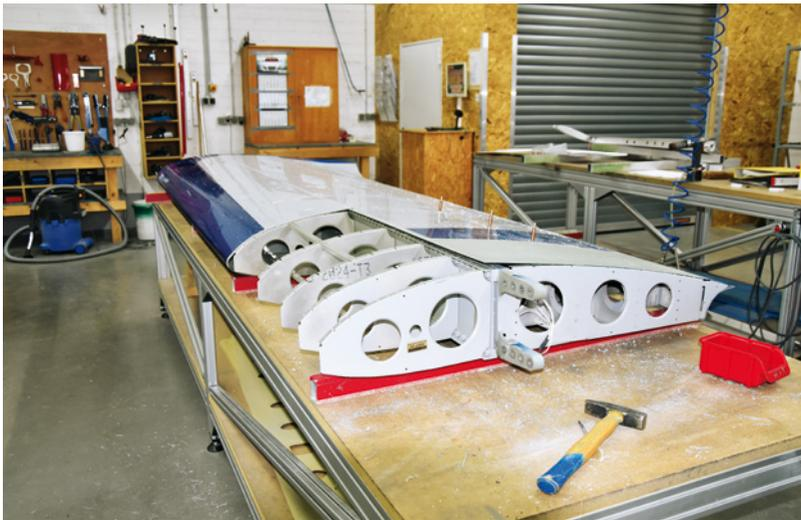
**Los geht's** Nahe der Flügelwurzel kommt die Beplankung runter, einige Rippen werden entfernt, der Holm erhält an der Hinterseite eine Aufdickung
