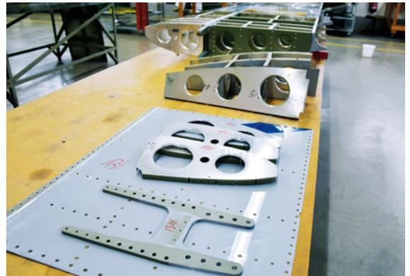
**Herausgenommen** alte Bauteile aus dem Flügel. Das 0,6 Millimeter starke Blech stammt von der Unterseite der Tragfläche
