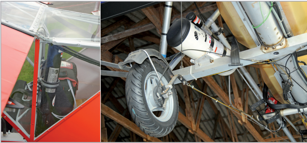
Abbildung 5: links: Softpack in einem UL-Tulak; rechts: Kapsel an einem UL-Skywalker
