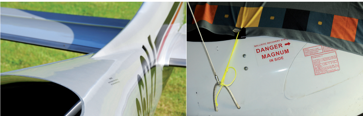
Abbildung 7: : links gekennzeichnete Ausstoßöffnung bei einer Cirrus SR22T; rechts: Ausstoßöffnung im unteren Bereich der Gondel eines Hängegleiters (seitlich)
