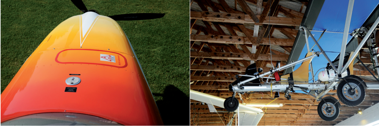
Abbildung 6: links: gekennzeichnete Ausstoßöffnung bei einer UL-Breezer; rechts: Ausstoßrichtung bei einem UL-Skywalker
