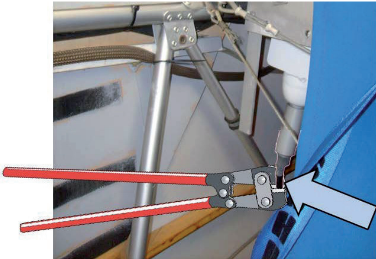
Abbildung 12: Trennung des Auslösekabels unterhalb der Startrakete
