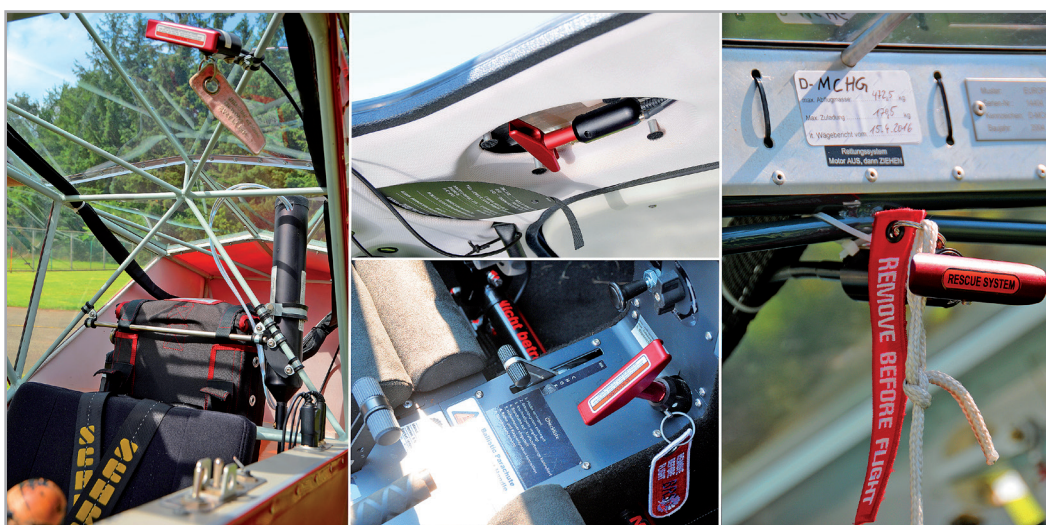
Abbildung 2: Verschiedene Einbauorte der Auslöseeinrichtung; links: UL Tulak; oben: Cirrus SR22T (ohne Sicherungsstift); unten: UL Breezer; rechts: UL-Eurofox
